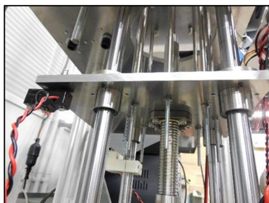
図 2 CFRP 穴あけ装置上下軸移動部
