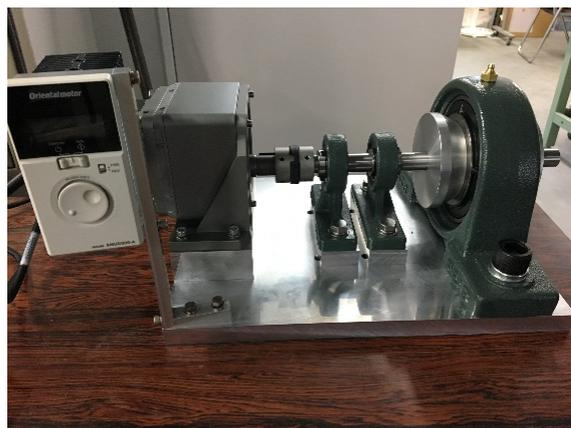
図5 破損軸受用音響値測定試験機
