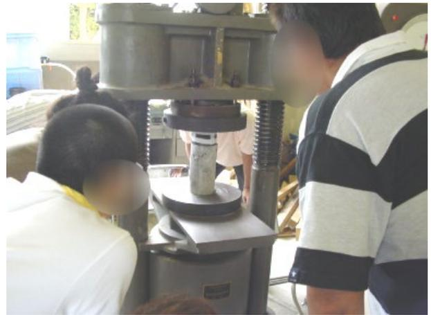
写真1 コンクリートの強度試験
