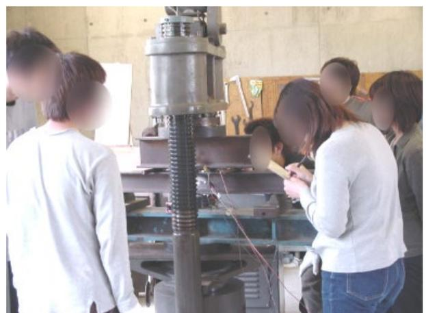
写真3 H型鋼の曲げ試験
