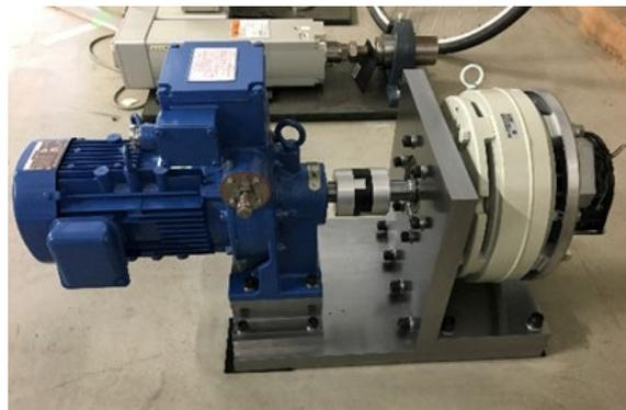
図4 サイクロ減速機用異常診断試験機
