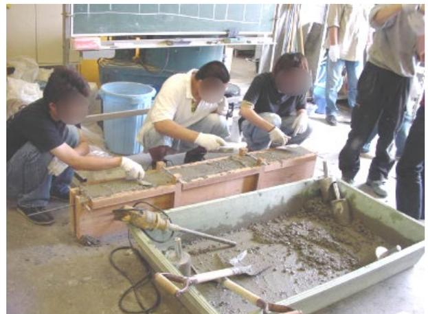
写真2 RCはりへのコンクリートの打設
