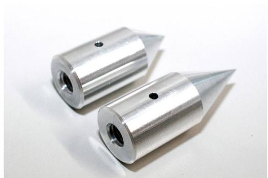
図1 放電実験装置の円錐状補集電極
