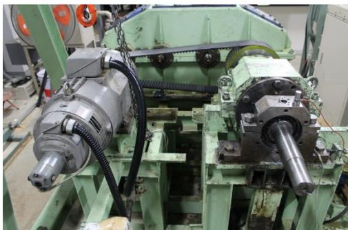
図4 改造を施した大型偏荷重試験機
