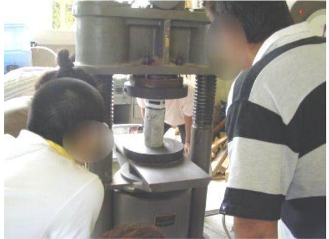
図 1 コンクリートの強度試験
